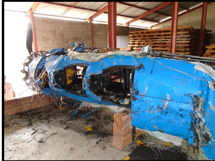
FOTOGRAFIA No. 5 Daños en la parte superior de la aeronave
