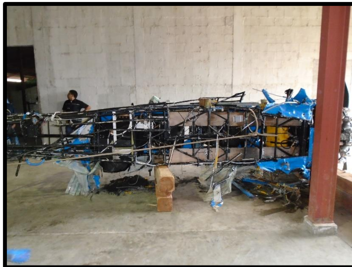
FOTOGRAFIA No.6 Daños en la parte inferior de la aeronave
