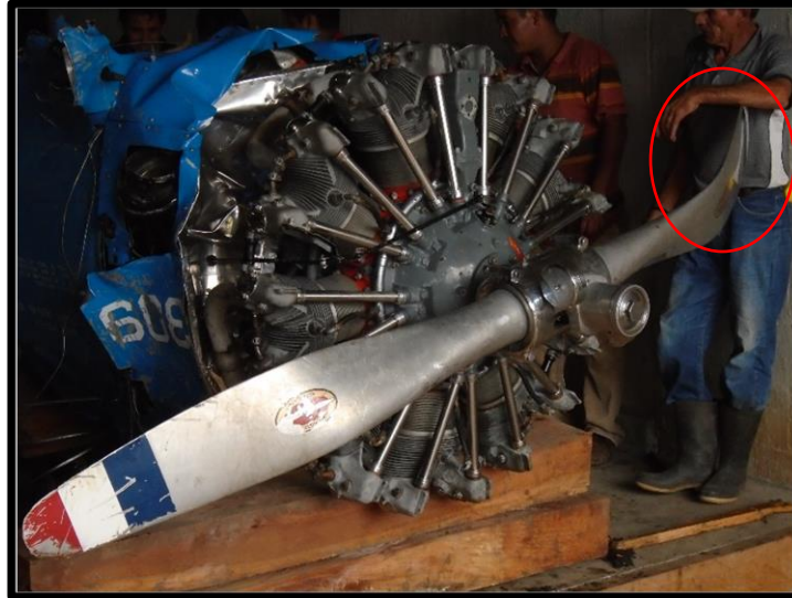
FOTOGRAFIA No. 7 Daños en la hélice
