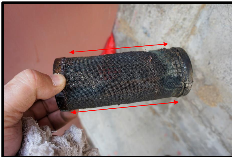
FOTOGRAFIA No. 20 Vista del filtro, mostrando el carbón sin material metálico.
