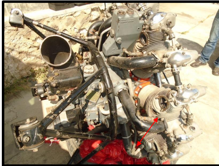
FOTOGRAFIA No. 14 Vista lateral, el motor tenía algunas bujías removidas.
