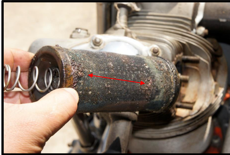
FOTOGRAFIA No. 17 Vista del filtro principal de aceite, con carbón.
